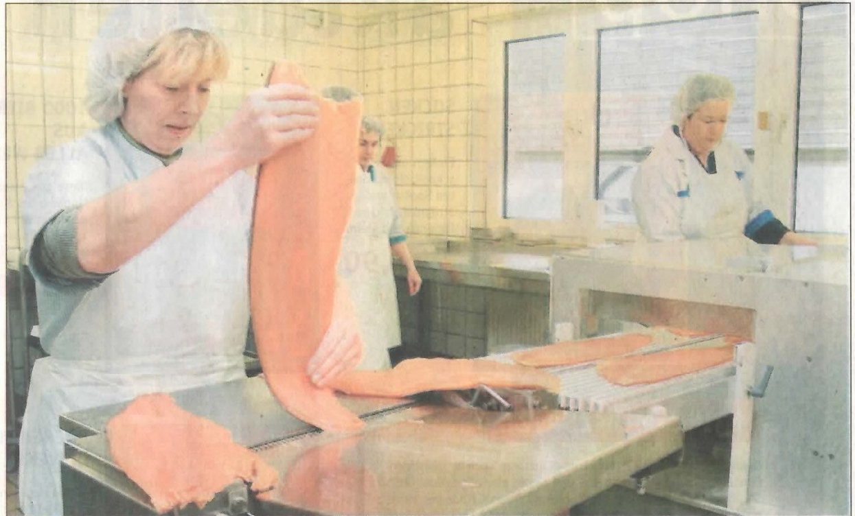
Lachsverarbeitung: Nach der maschinellen Enthäutung legt Christina Böttcher von der Fischräucherei Apel (links) die Lachshälften aufs Band, das den Fisch durch die Schneidemaschine transportiert. Den geschnittenen Lachs nimmt dann Firmenchefin Heike Kessler (rechts), um ihn zu verpacken.
